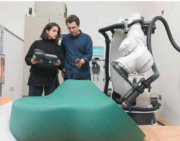
**Filamente aus dem Handgelenk:** Die Kuka-Roboter tragen präzise Bahn für Bahn auf
